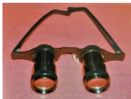
Figura 3 – Sistema telescópico binocular de Galileu. Fonte: Haddad et al, 2010, p. 129.
