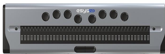
Figura 15 – Linha Braille Esys 40. Fonte: Tecassistiva 9 , 2018.
