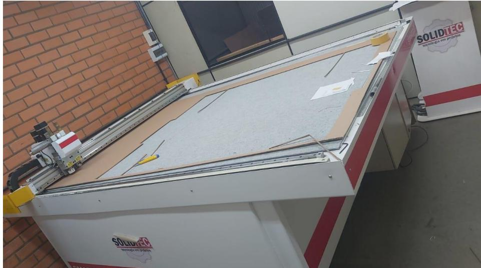
**Figura 3 - Equipamento utilizado para o corte do papelão. Fonte: De autoria própria, 2022.**
