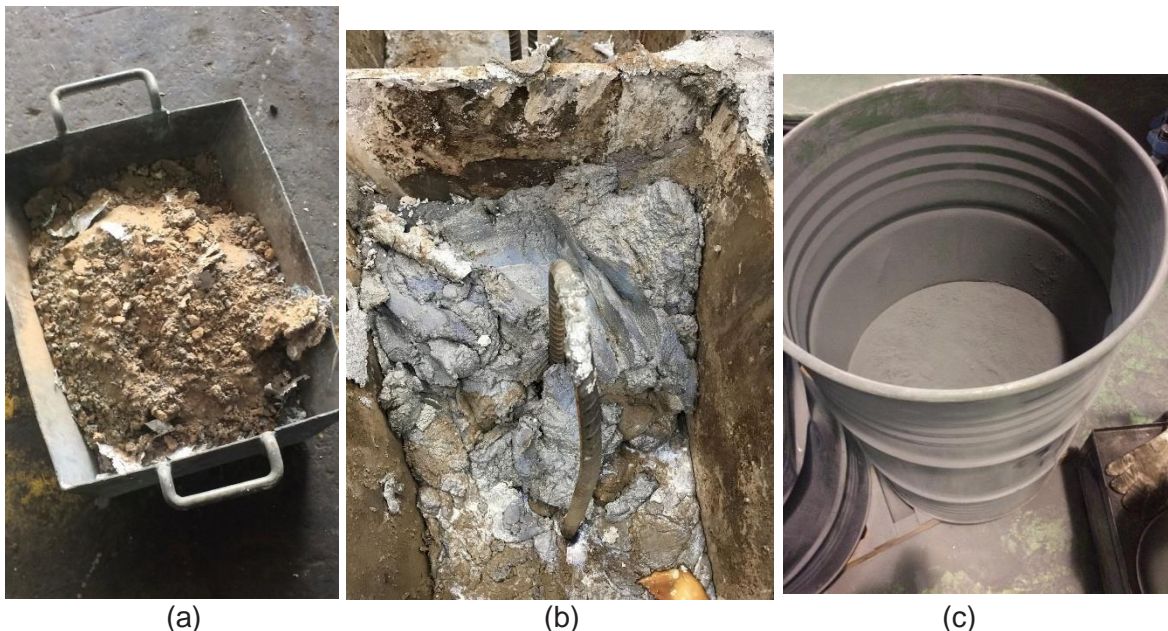
Figura 4: (a) Cinza de Zinco, (b) Borra de Zinco, (c) Pó de Zinco. Fonte: autoria própria.
