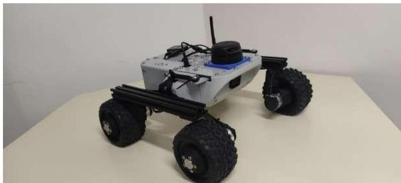
**Figura 3: Base móvel Leo Rover.**
