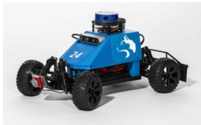
Figura 5 – Robô de rodas de baixo custo e de código aberto.
