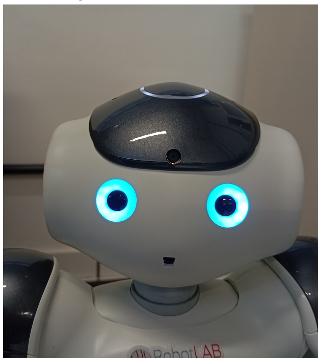
Figura 2 – Leds do robô NAOv6
